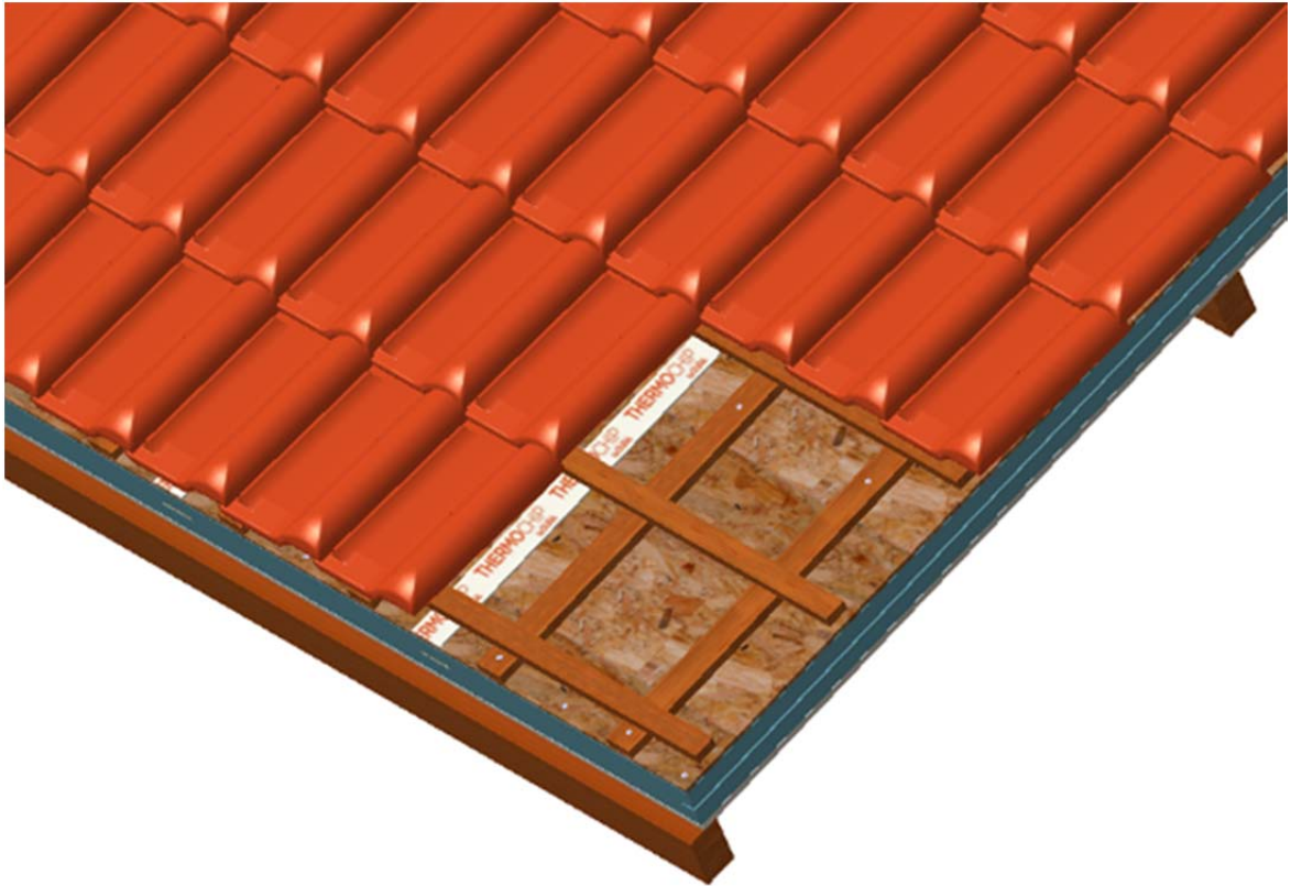
Figure 20 – Principe de mise en œuvre des couvertures de petits éléments (tuiles, ardoises...)
